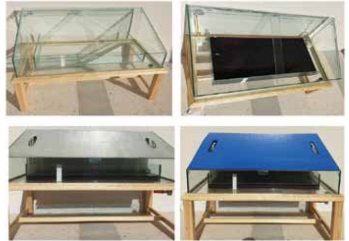
الشكل 1. صورة للنموذج المغلق للتبخر الطبيعي لمادة المرجين.
