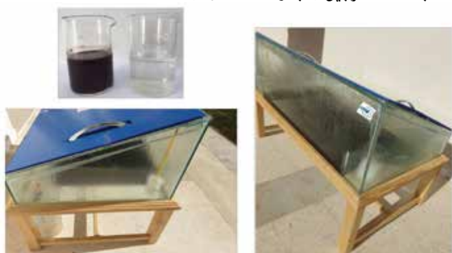
الشكل 5. تجميع المياه المتبخرة أثناء معالجة مادة المرجين.
